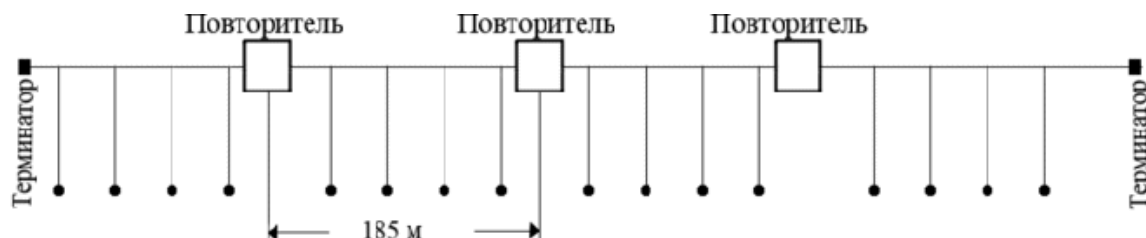
Рис. 4. Соединение сегментов в шинной топологии
